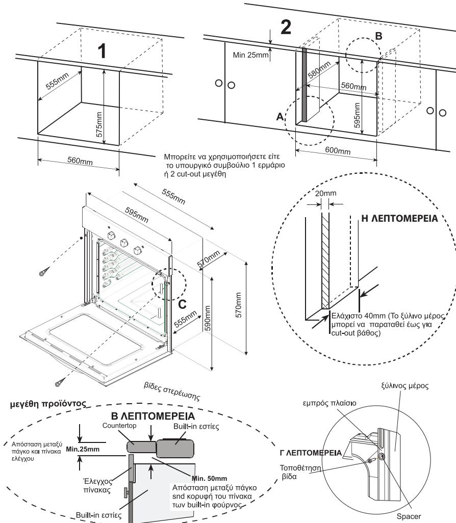
Τοποθετήστε το φούρνο στο ντουλάπι σπρώχνοντάς τον προτάτε εμπρός. Ανοίξτε την πόρτα του φούρνου και τοποθετήστε 2 βίδες στις οπές στο πλαίσιο του φούρνου. Σφίξτε τις βίδες διατηρώντας το πλαίσιο της συσκευής σε επαφή με την ξύλινη επιφάνεια του ντουλαπιού.
